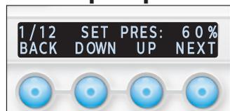
6. Presione “DOWN” o “UP” para ajustar la frecuencia al nivel deseado, luego presione “NEXT”.
