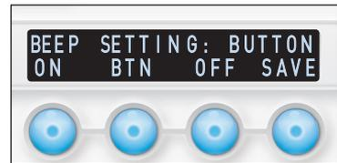
La selección actual para el ajuste de pitidos se muestra en la línea superior de la pantalla. Presione “SAVE” para salir del menú y guardar el ajuste de pitido seleccionado.
